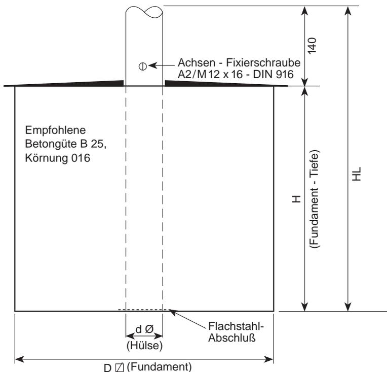
Der um 360° drehbare ROFA-Mast bedarf auf 1,70m umlaufend um Mastachse unbehinderte Ausleger-Beweglichkeit (z.B. sind Bäume, Hauswände, Leitungen usw. zu berücksichtigen).
